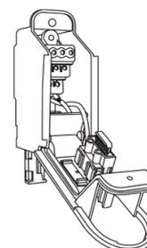
*Morsettiera in doppio isolamento, completa di portafusibile, grado di protezione perimetro cerchio IP43 secondo CEI EN 60529. Grado di protezione ingresso cavi IP23 secondo CEI EN 60529. Resistenza all'urto IK 08 secondo CEI EN 50102.*
