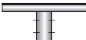
*Traversa in acciaio S235, zincato a caldo secondo UNI EN ISO 1461*
